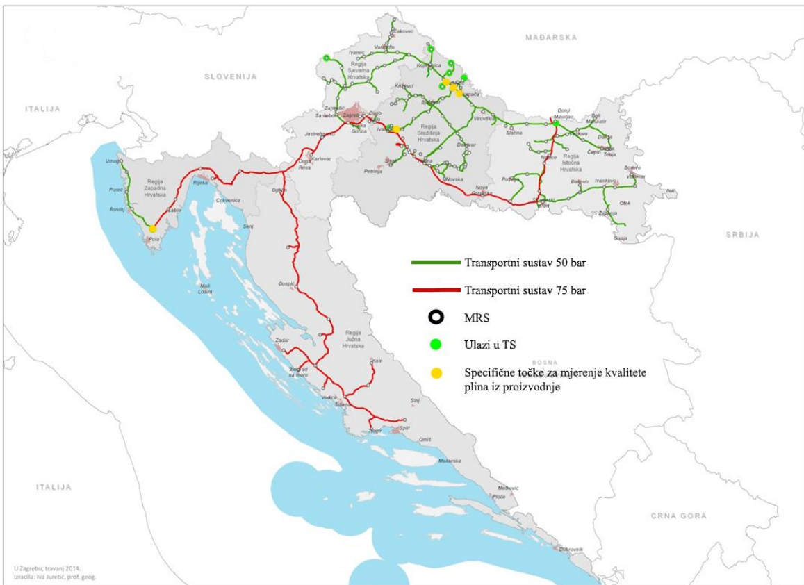
Slika 1: Transportni sustav RH 2018. godine i specifične točke za mjerenje kvalitete plina iz domaće proizvodnje ( www.plinacro.hr ).
