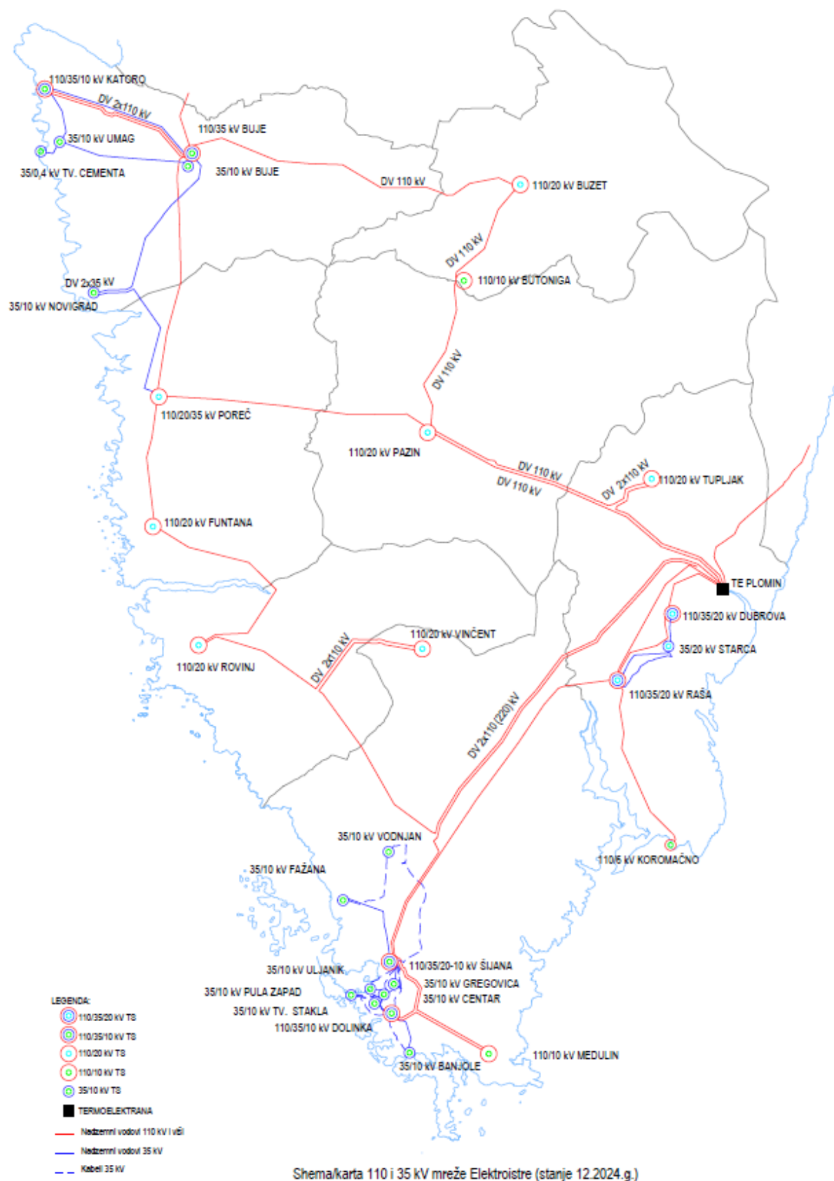
Slika 2. Topološki prikaz 110 kV i 30(35) kV mreže distribucijskog područja
