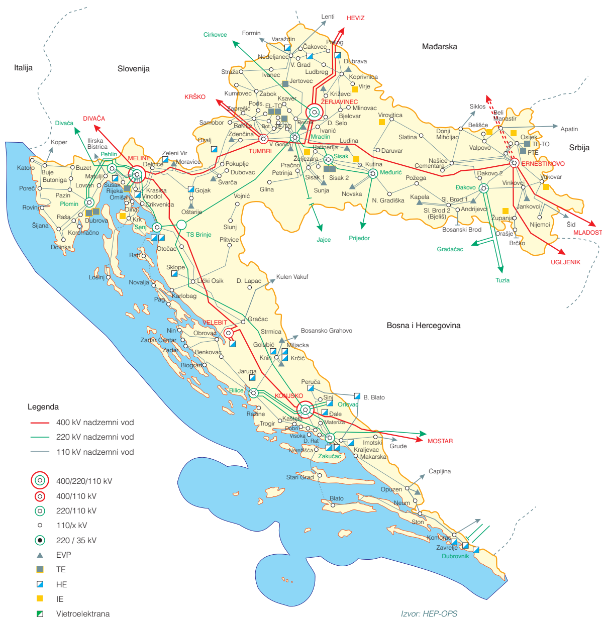
Slika 3.1.1. Shema prijenosne mreže i proizvodnih objekata hrvatskog elektroenergetskog sustava
