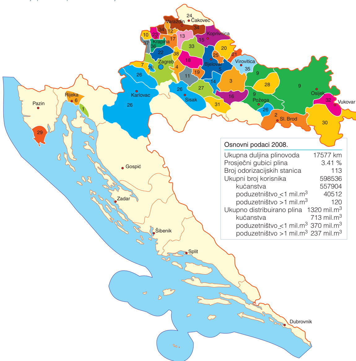
Slika 4.1.4. Raspored distribucijskih područja operatora distribucijskog sustava i osnovni podaci o energetske djelatnosti distribucije plina u Republici Hrvatskoj u 2008.
