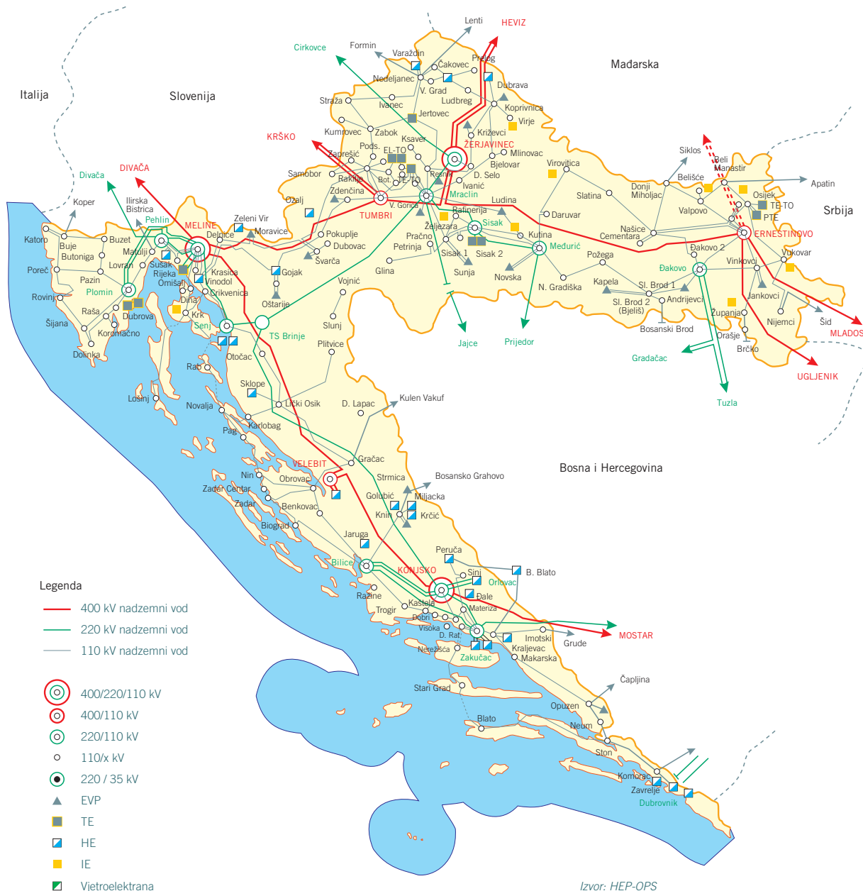
Slika 3.1.1. Shema prijenosne mreže i proizvodnih objekata hrvatskog elektroenergetskog sustava
