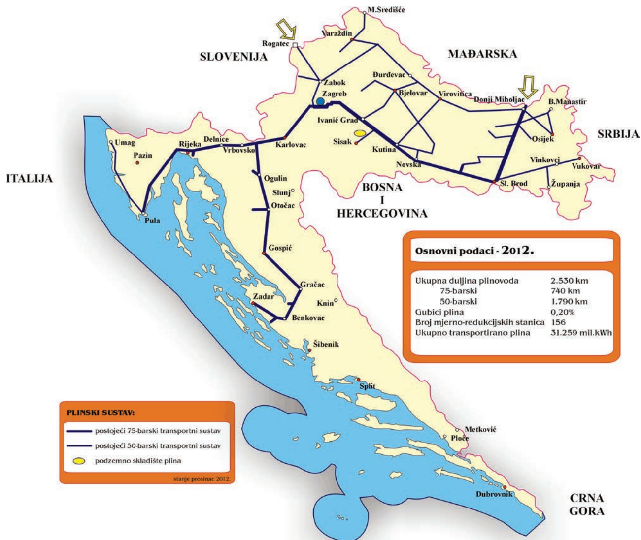
Slika 5.1.1. Postojeći plinski transportni sustav Republike Hrvatske
